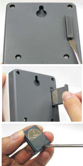
Fig. 06 – Instruções para substituir a bateria do Timer TM-6331
