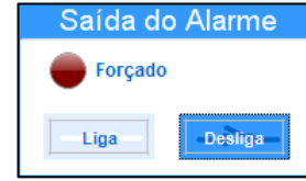
Fig. 22 – Saída de alarme com forçamento em estado desligado
