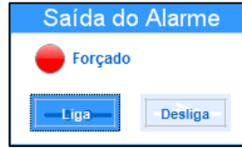
Fig. 21 – Saída de alarme com forçamento em estado ligado
