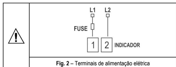
Fig. 2 – Terminais de alimentação elétrica
