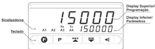
Fig. 12 – Identificação das partes do painel frontal
