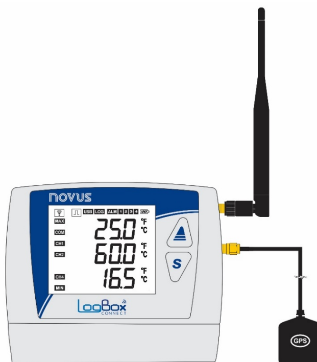
Figura 46 – Interface celular e GPS
