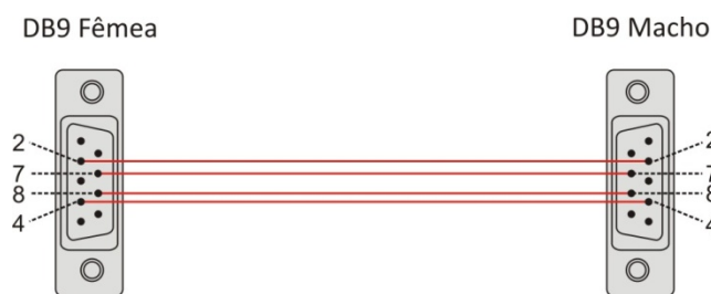
Figura 112 Confeção do cabo de extensão
