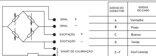
NOTA: O sinal de saída é positivo para cargas de tração e para calibração e negativo para cargas de compressão.
