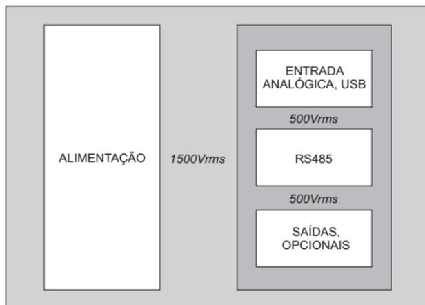
**Obs.:** Caso a saída seja tipo relé, a isolação dielétrica será de 1500Vrms em relação a qualquer outro potencial elétrico do controlador.
