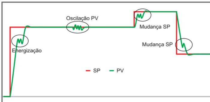
**Obs.:** em processos nos quais a estrutura ou o meio pouco se alteram, recomendamos utilizar a opção A.t que, uma vez sintonizada, não mais interfere na rotina do processo.
